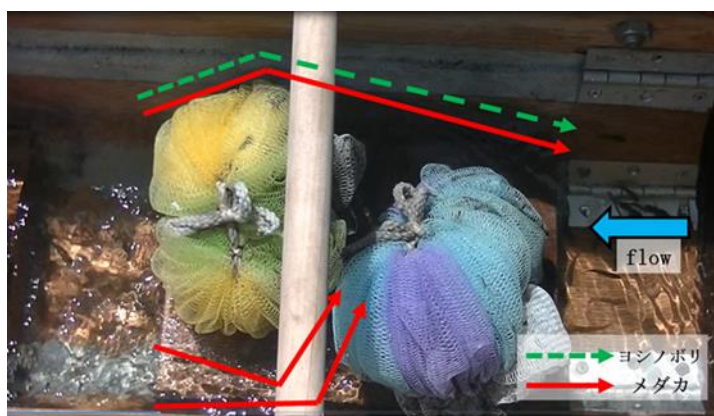
Fig. 4 水制ブロック区間における魚類遡上経路
